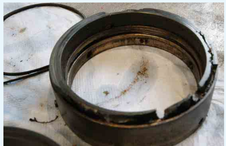
Schaden an einer Gleitringdichtung
