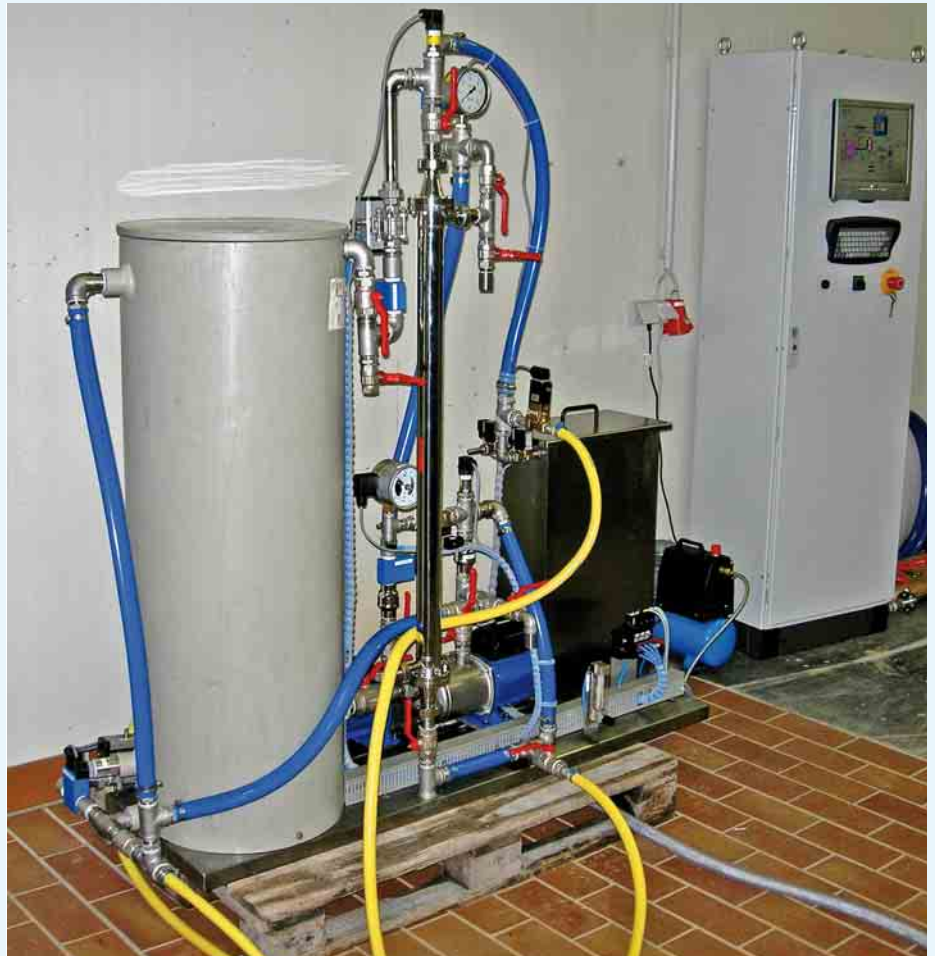
KLEINTECHNISCHE ANLAGE: zur Untersuchung verschiedener keramischer Membranelemente Foto : TZW
