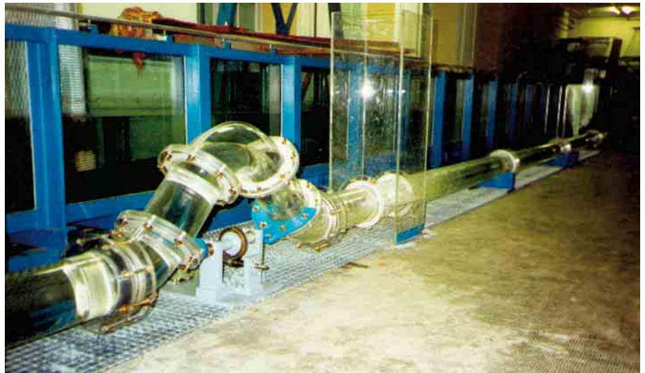
HUBERT-ENGELS-LABOR: hydraulische Modelluntersuchung des Drehbogens
