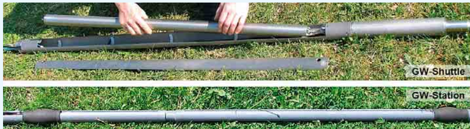
PROBENAHMESYSTEM: GW-Shuttle und GW-Station
