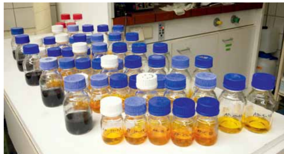
Bild 1 Adsorptionskonkurrenz in Kläranlagenabläufen wurde mit Methylorange getestet.
